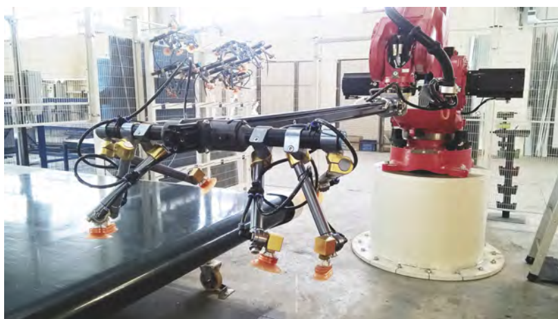
Fig. 9 – Organo di presa a ventose e magazzino braccetti.
