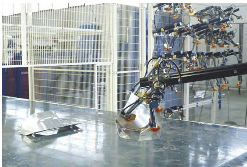
Fig. 8 – Posizionamento di pezzo su nastro trasportatore.
