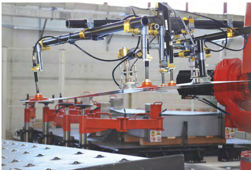
Fig. 5 – Organo di presa per fogli di lamiera di grossa dimensione.
