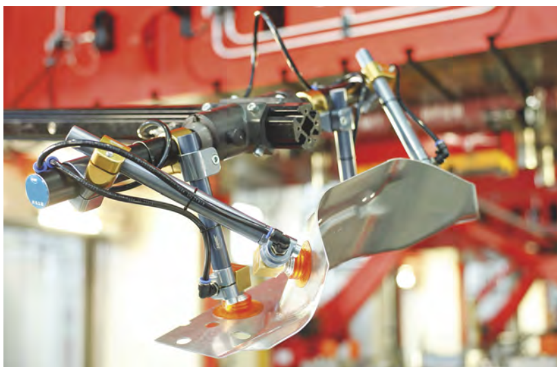
Fig. 7 – Primo piano di presa a ventose.
