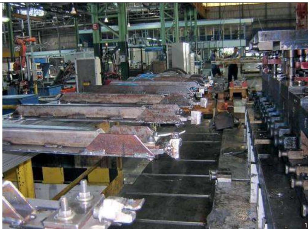
Fig. 1 – Braccetti di manipolazione simultanea dei cicli di tutte le presse che devono operare in linea. inizio anni 2000.
